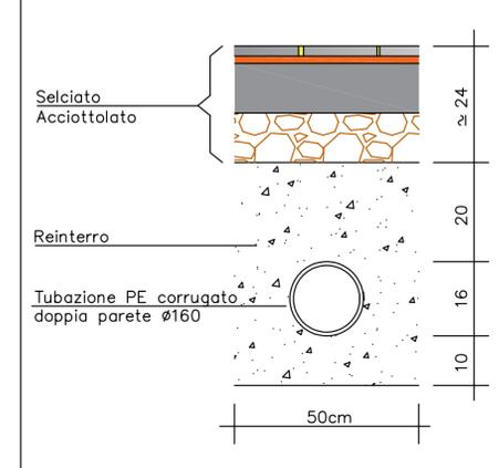
Sezione tipo scavo nuova tubazione acquedotto
