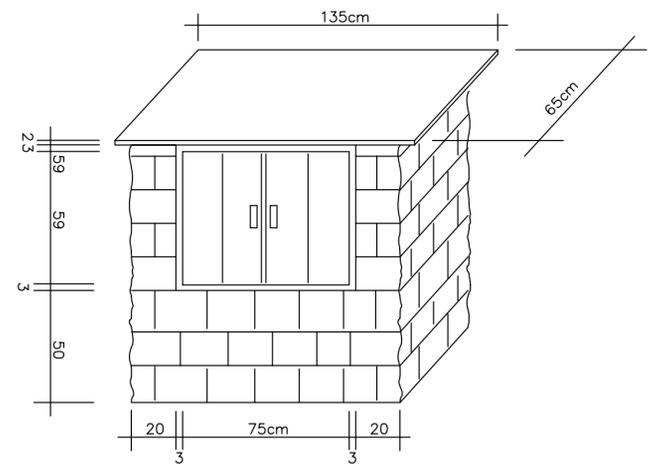
Colonnina tipo doppia per alloggiamento scatole ENEL-TIM, in muratura in scapoli di cava con malta cementizia, beola da tetto spessore 2cm e serramento in legno.
